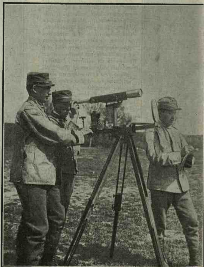
Con le nostre truppe ol' re l'Isonzo. — Diottico semiparlante per la tel. grafica usata dai nostri telegrafisti nell'avanzata, precedendo esso l'impianto delle linee telegrafiche. (Fot. Argus - lastre Cappelli).
