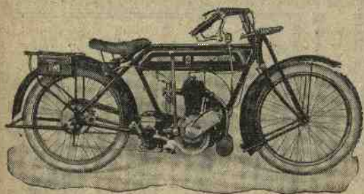
MOTO FRERA 3 1/2 HP - Mod. F (Cilindr. 500 cm 3 ).
